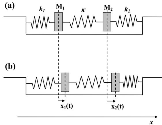
FIGURE 2 – Système de deux oscillateurs couplés. (a) : les masses  $M_1$  et  $M_2$  sont au repos. (b) : Mises en mouvement, elles sont repérées par  $x_1(t)$  et  $x_2(t)$ .
