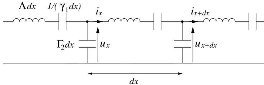
II.12. En passant en notation complexe, exprimer grâce aux lois des mailles et nœuds, les différentielles  $d\underline{u} = \underline{u}(x + dx) - \underline{u}(x)$  et  $d\underline{i} = \underline{i}(x + dx) - \underline{i}(x)$ .
