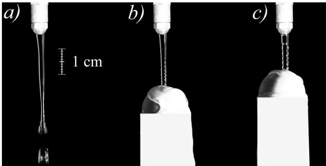
FIGURE 5 – Photographies d’un filet d’eau de débit  $Q = 2 \text{ g} \cdot \text{s}^{-1}$ , à la sortie d’un tube de rayon  $R_0 = 1 \text{ mm}$ . a) Apparition de gouttes; b) et c) Chute sur un obstacle.
