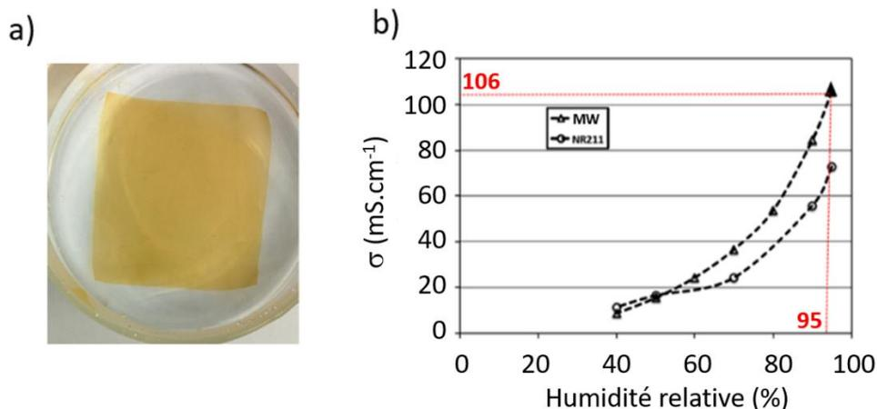
**Figure 7.** a) Morceau de membrane MW. b) Conductivité de la membrane MW en fonction du pourcentage d'humidité relative mesurée à  $30^\circ\text{C}$ . NR211 correspond à la membrane Nafion® de référence.
