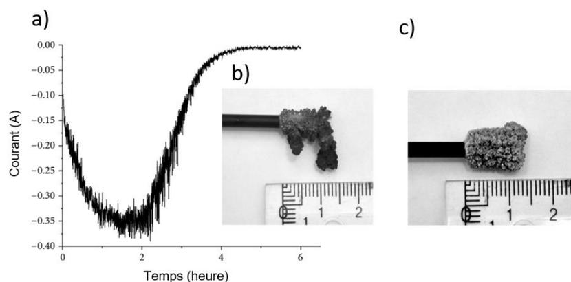
**Figure 10.** Séparation électrochimique du Cu(II) et de l'In(III) du mélange Cu(II), In(III), Ga(III) : a) courant traversant le circuit en fonction du temps au cours de l'électrolyse pour un potentiel imposé à la cathode de  $E = -0,30$  V/ENH. b) Photo du dépôt de cuivre sur l'électrode de carbone vitreux. c) Photo du dépôt d'indium sur l'électrode de carbone vitreux après électrolyse à un potentiel imposé de  $E = -0,90$  V/ENH.
