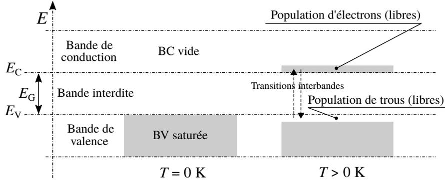
FIGURE 1 – Illustration de l’occupation des niveaux électroniques dans un semi-conducteur à partir de son schéma de bande. L’axe des ordonnées porte l’énergie  $E$  des niveaux électroniques dans le cristal semi-conducteur. Pour  $T > 0$  K un équilibre thermodynamique s’établit entre les transitions interbandes de BV à BC et celles de BC à BV.
