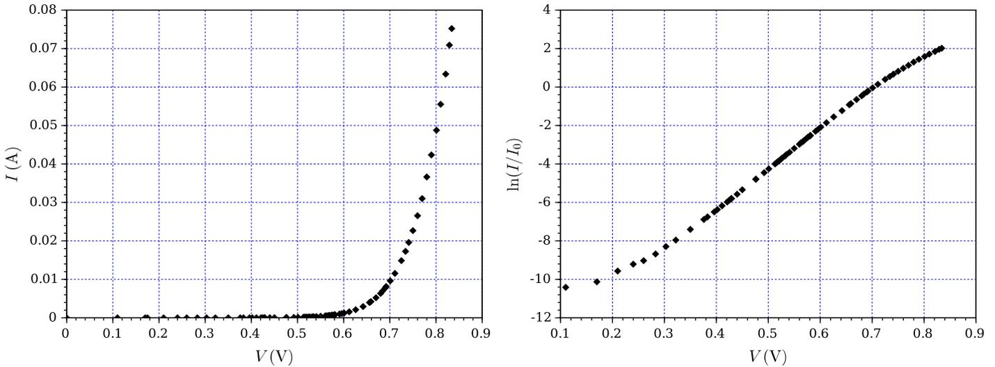
FIGURE 8 – Caractéristique expérimentale  $I = I(V)$  d'une diode 1N4148 (pour  $T = T_a$  et  $V \geq 0$  (V)). L'axe des ordonnées du tracé de droite porte le logarithme népérien du rapport  $I/I_0$  où  $I_0$  est un courant de référence.
