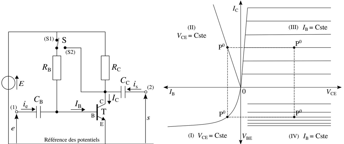
FIGURE 11 – Figure de gauche : transistor placé dans un circuit de polarisation (nous considérons, dans cette sous-section (3.2) que  $e = s = 0$  (V)). Figure de droite : réseau de caractéristiques (idéalisé) du transistor. Un point de repos (ou de polarisation)  $P^0$ , arbitraire, du transistor y est représenté.
