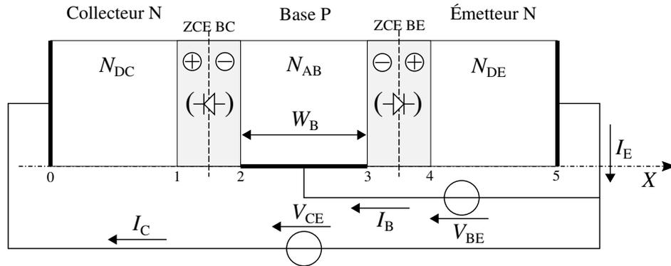
FIGURE 9 – Structure générale d'un transistor bipolaire NPN. Ce transistor est placé dans un environnement électrique constitué de deux générateurs de tension fixant les différences de potentiel  $V_{BE}$  et  $V_{CE}$ . La diode représentée entre parenthèses dans chacune des ZCE indique la polarité de la jonction PN correspondante.
