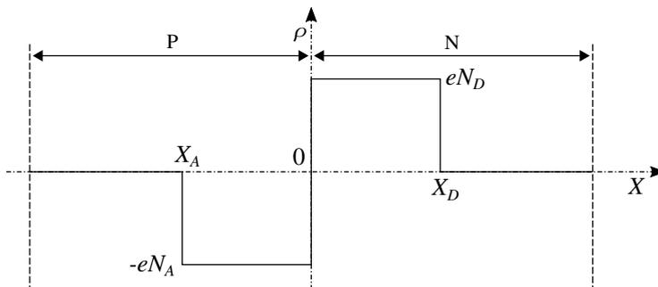
FIGURE 5 – Répartition spatiale adoptée de la densité volumique de charge  $\rho = \rho(X)$ , le long du semi-conducteur PN.
