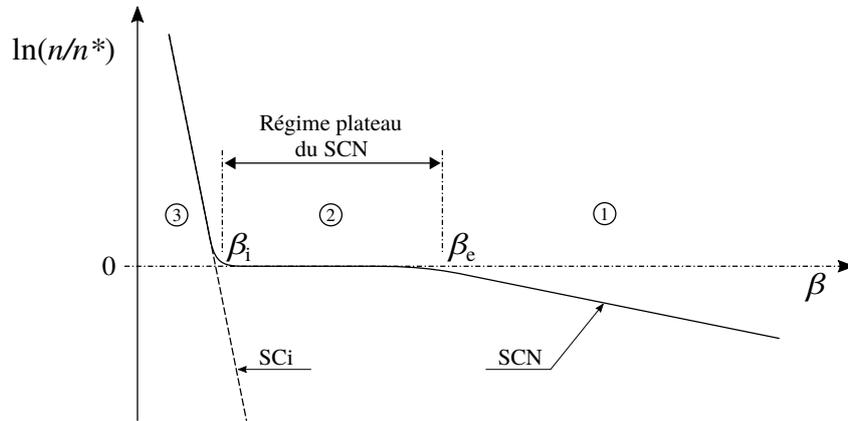
FIGURE 3 – Allure générale de la dépendance de la concentration  $n$  d'électrons libres de la bande de conduction en fonction de  $\beta = 1/(k_B T)$ , pour un semi-conducteur SCi et un semi-conducteur SCN. Le tracé en trait plein est relatif au SCN et celui en trait pointillé au SCi. Sur le domaine ③, ces deux tracés se superposent (sensiblement).
