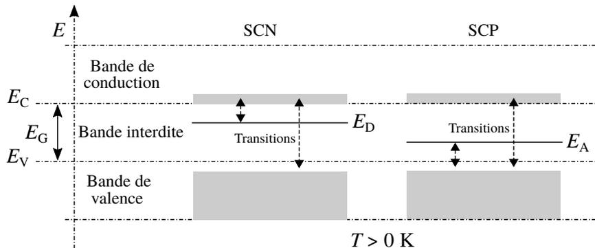
FIGURE 2 – Schémas de bande correspondant à un SCN et un SCP. À la température  $T > 0$  K, un équilibre thermodynamique s’établit entre les transitions montantes et descendantes entre BV et BC d’une part, et entre le niveau  $E_D$  (ou  $E_A$ ) et BC (ou BV) d’autre part.
